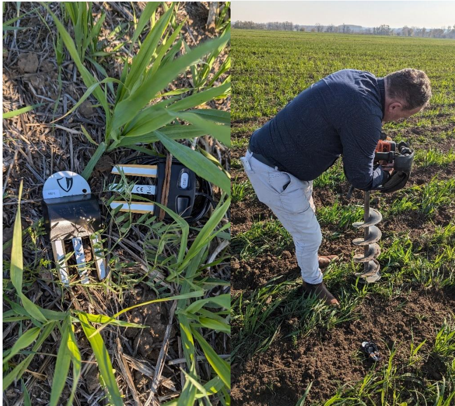
5. ábra Talajszenzor és telepítésük folyamata
